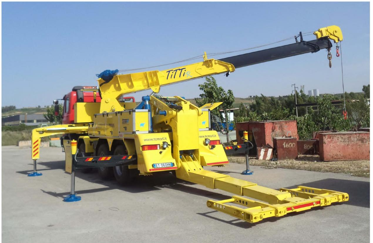
L'attrezzatura **TITTI R** è applicabile su autocabinati a 4 assi. Grazie ad una particolare facilità d'uso è adatta al recupero ed al trasporto con asse sollevato di automezzi pesanti in avaria.
